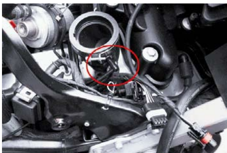
Luftfilterkasten und Drosselklappe entfernt. Unterdruck hergestellt am
