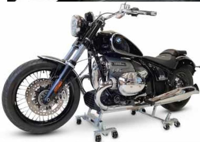
Front-Partie wird erst eingesetzt wenn Maschine hinten aufgebockt ist!
