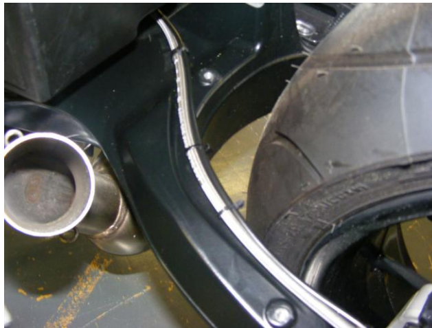
Bild1: Befestigung mittels Kabelbinder
