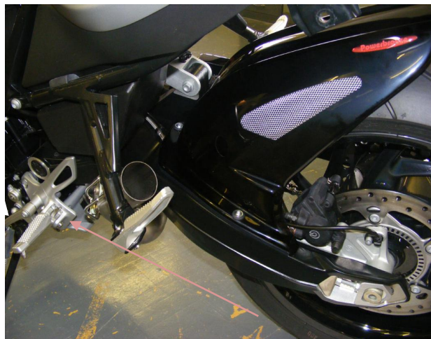
Bild 3: Befestigung mittels M6x25 Schrauben. Kantenschutz zwischen Radabdeckung und Schwinge montieren M6 U-Scheiben bei Bedarf zur Ausrichtung der Radabdeckung verwenden
