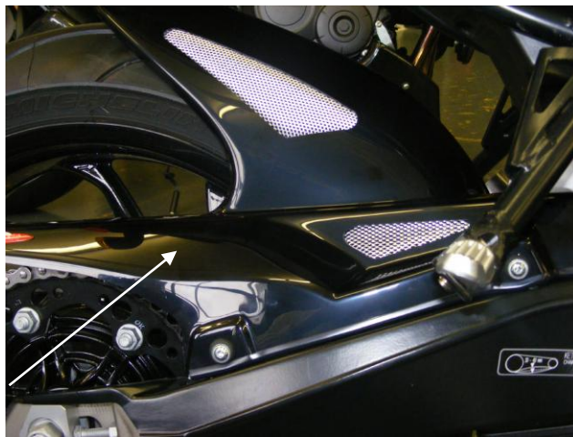
Bild 2: Befestigung mittels M6x20 Schrauben Kantenschutz zwischen Radabdeckung und schwinge montieren
