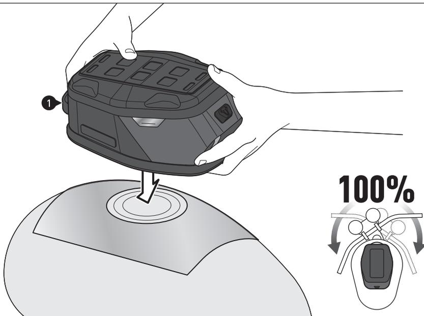
Setzen Sie den Tankrucksack (1) auf. Stellen Sie sicher, dass die Magnete vollflächig auf der Metalloberfläche haften.
