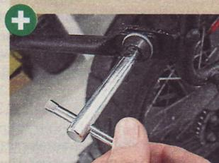
**Givi:** Das mitgelieferte Miniwerkzeug hilft beim Öffnen und Schließen der Schnellverschlüsse
