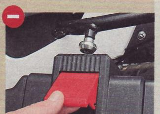
**BMW:** Hakiger Verschluss, Vario-Koffer war im Test mitunter schwer von Maschine zu lösen
