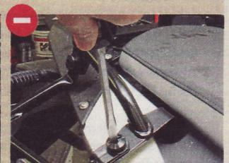
**SW-Motech:** Quicklock-System – Demontage nur mit großem Schraubendreher möglich
