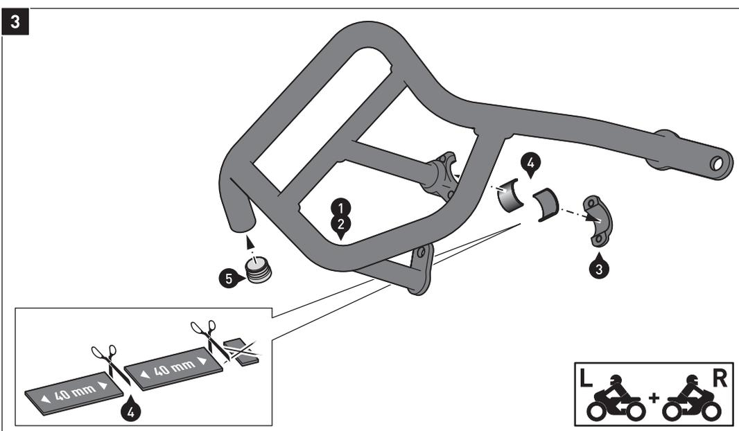
Schneiden Sie die beiden Gummistreifen [4] in je zwei 40-mm-Stücke (der Rest entfällt).
