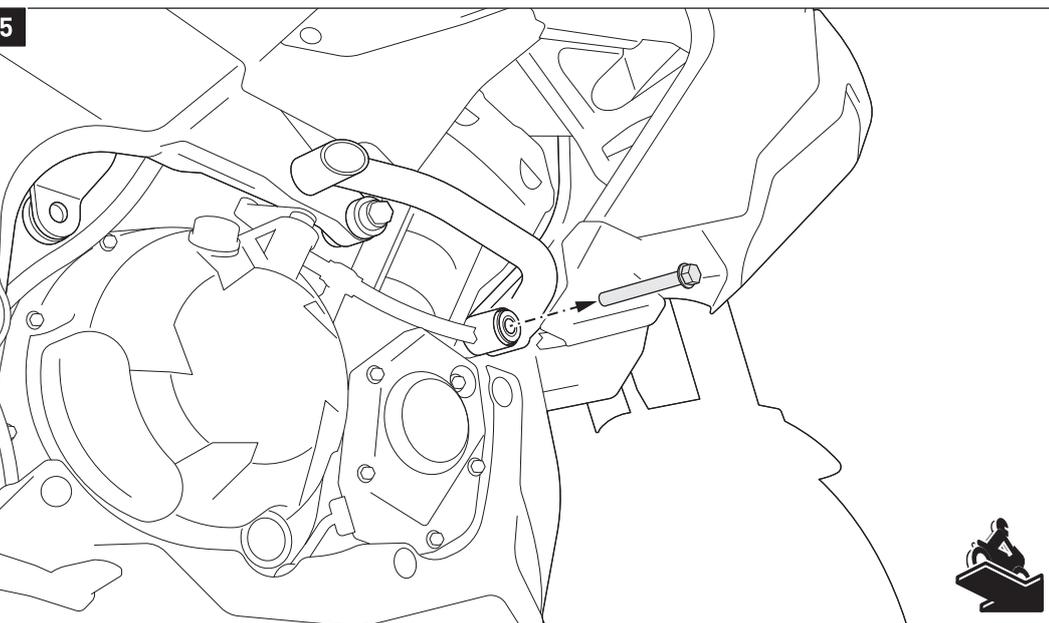
Entfernen Sie die gezeigte Schraube auf der **rechten** Fahrzeugseite.
