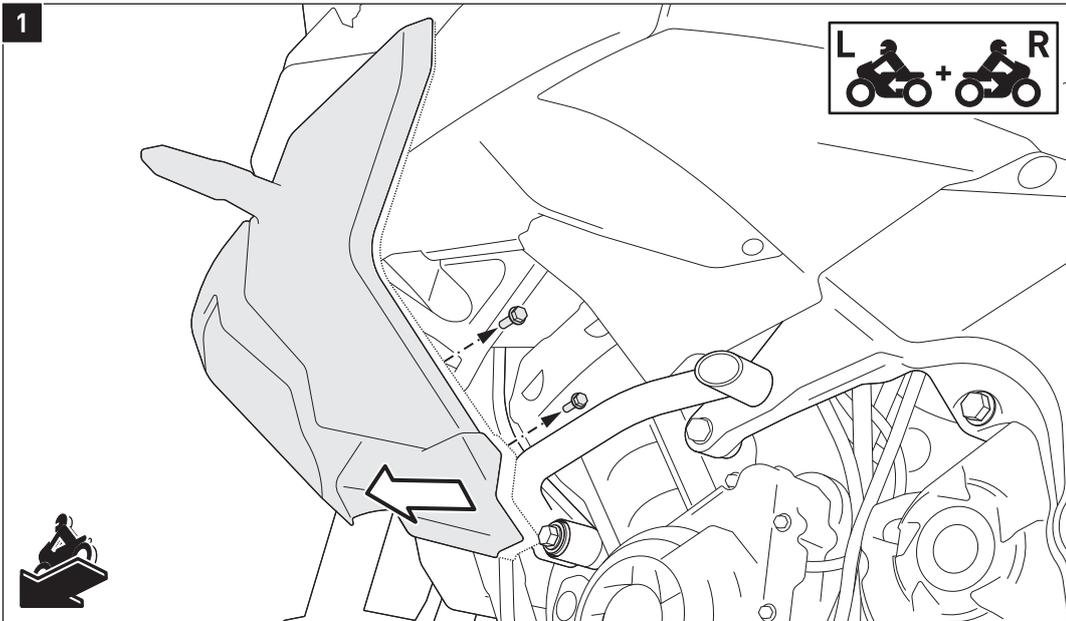
Lösen Sie beidseitig die gezeigten Schrauben der Seitenverkleidungen. Drücken Sie anschließend die Seitenverkleidungen etwas nach außen.
